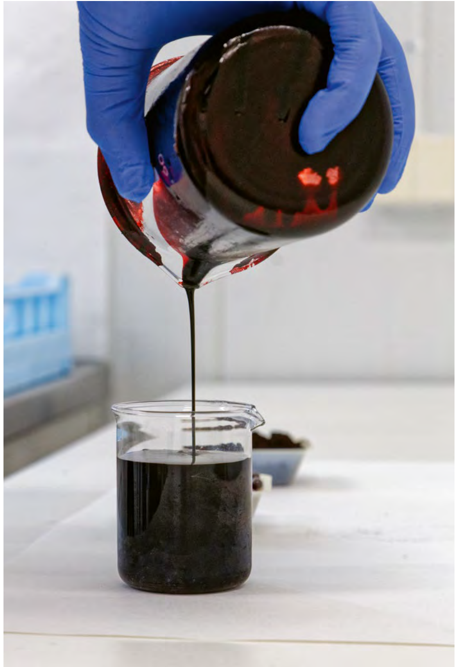
Die Anthocyane der Beeren werden bei MedPalett schonend konzentriert. Vor dem Trocknen sind sie ein dickflüssiger Sirup.
