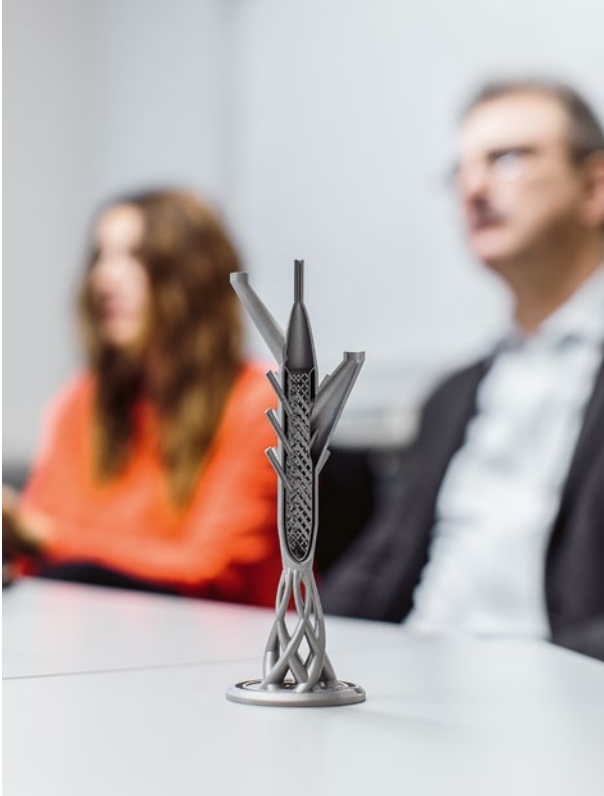
Das Innenleben eines aus Stahl gedruckten Demonstrationsobjekts
