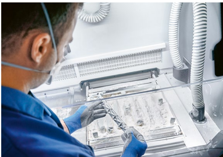
BMW setzt bei der additiven Fertigung unter anderem auf Multi-Jet Fusion.
