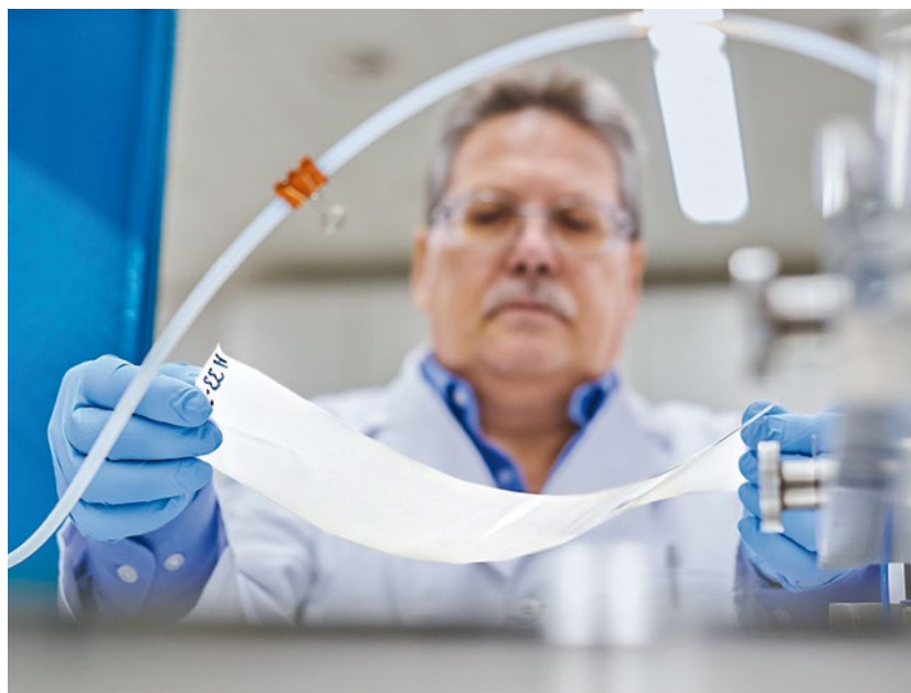
Anwendungstechniker Herbert Habermann kontrolliert einen Separator, der beidseitig mit Aluminiumoxid beschichtet wurde.
