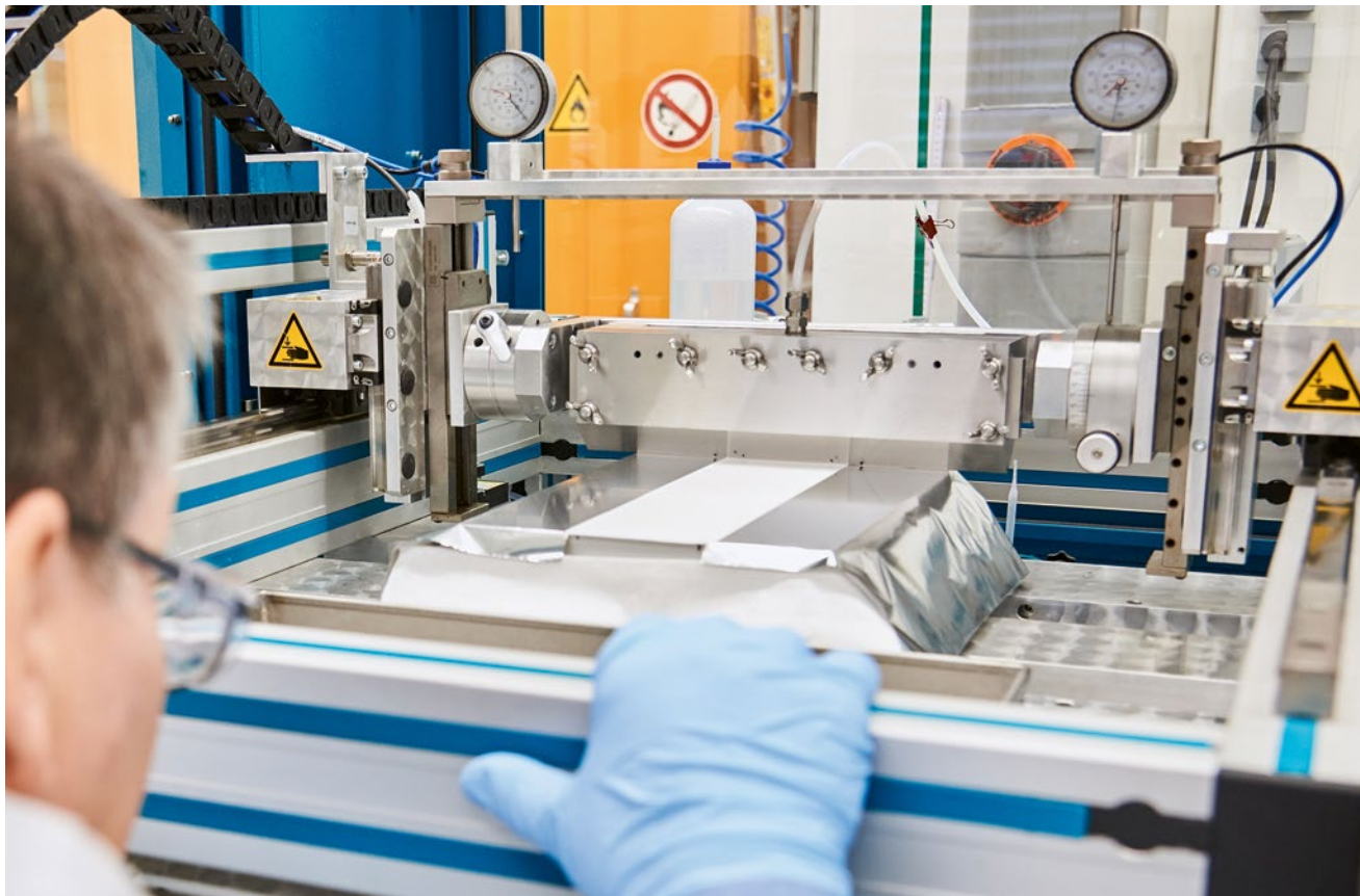
Feine Sache In der Anwendungstechnik in Hanau demonstriert Evonik, wie man Separatorfolien mit einer keramischen Beschichtung versieht.
