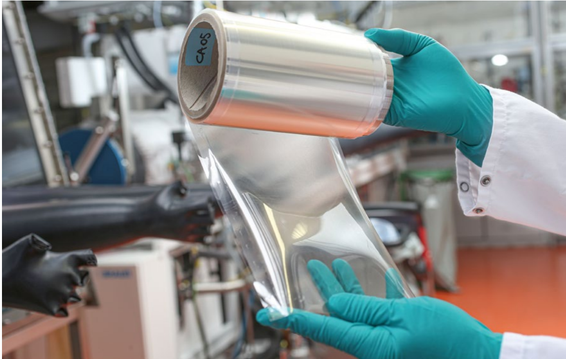
Erst fest, dann flüssig, dann flexibel: Im Creavis-Labor wird Polymerpulver komponiert (rechts oben), das dann in gelöster Form (rechts) zu Endlos- membranen (oben) gegossen wird.
