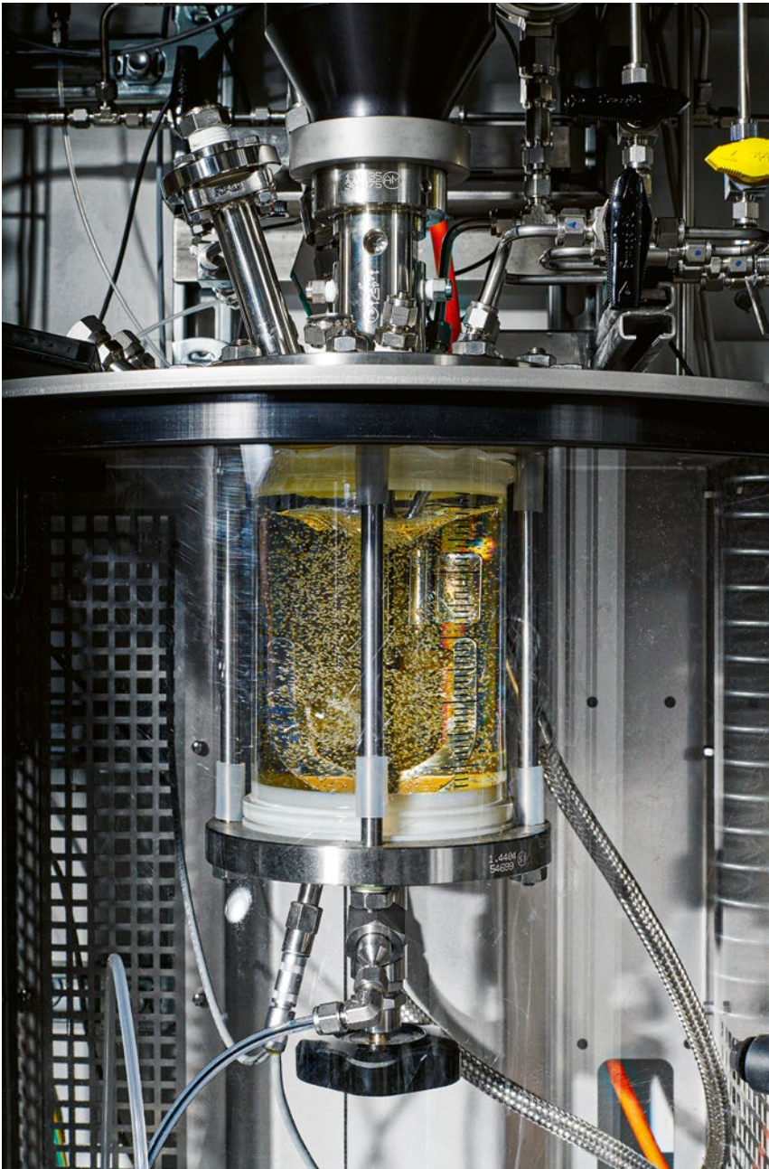
Der gläserne Ein-Liter-Reaktor im Hanauer Evonik-Labor kommt bei Versuchen zum Einsatz.
