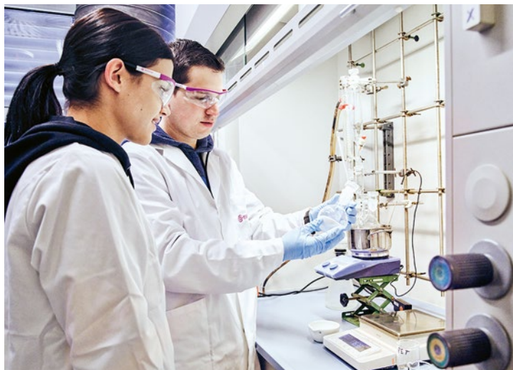
Als Hauptprodukt der PET-Methanolyse erhalten die Labormitarbeiter Dimethylterephthalat, einen weißen Feststoff.
