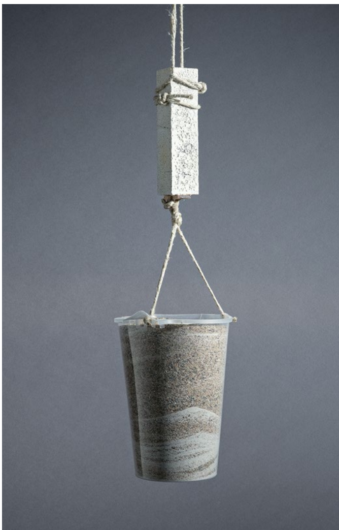
Der Langzeittest zeigt: Ein bakteriell gekitteter Riss hält auch starken Belastungen stand.
