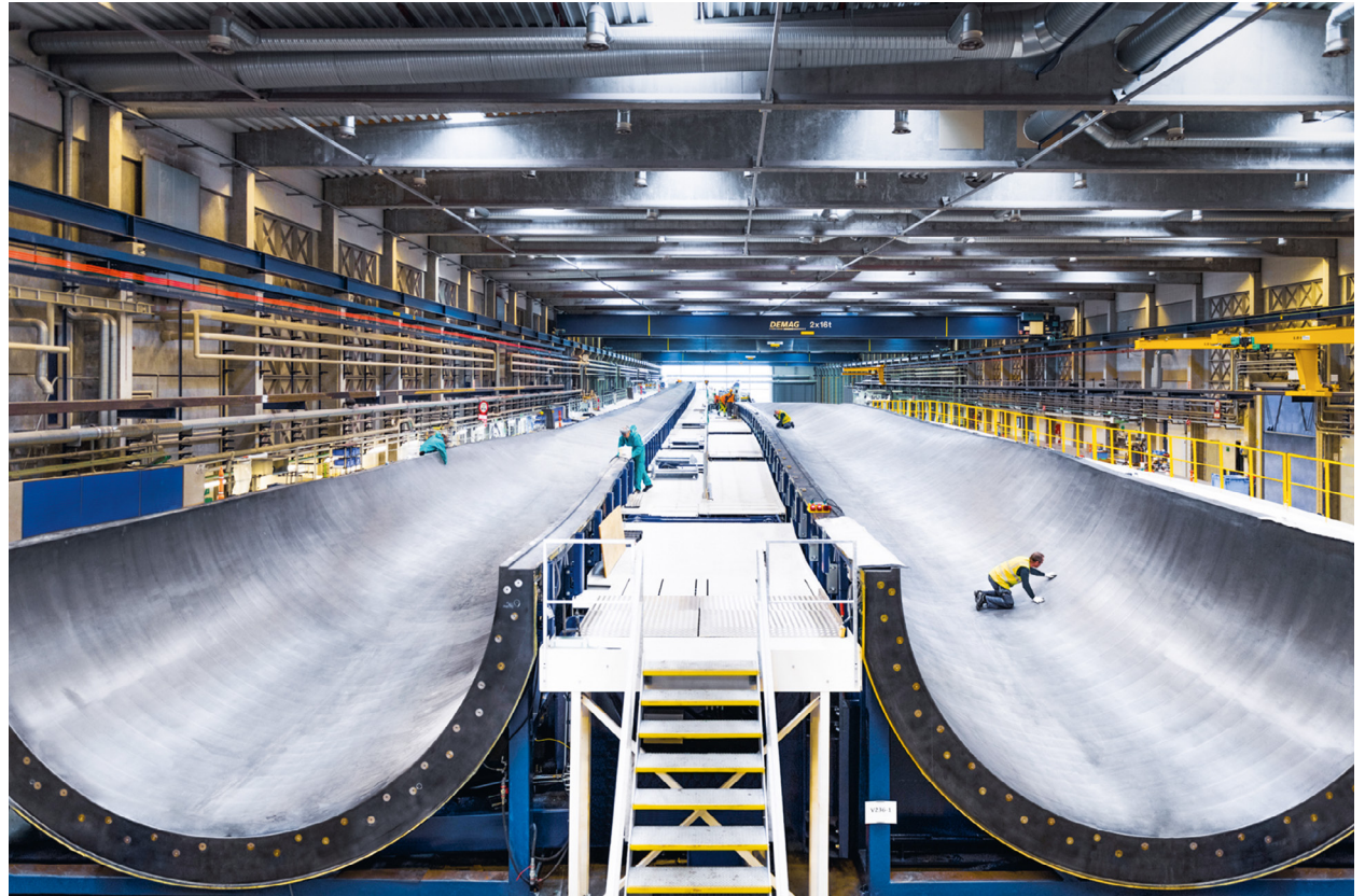
Mehr als 100 Meter lang sind die Formen, in denen wie hier bei Vestas in Dänemark die Rotoren der großen Windkraftanlagen gefertigt werden.
