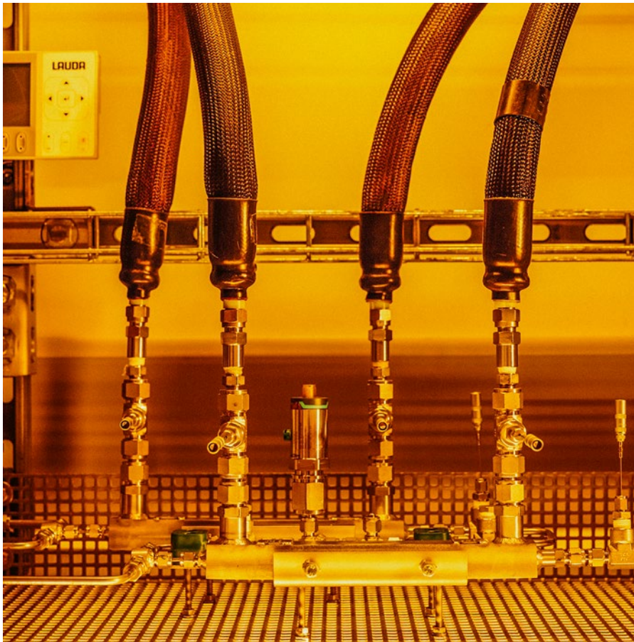
Das Herzstück der Testapparatur: An die Stelle des vorderen waagerechten Rohrs (l.) tritt in Kürze die 3D-gedruckte Version.
