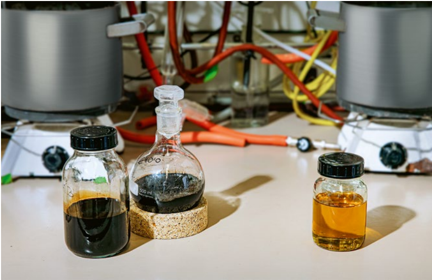
Bei der Hydrolyse entsteht eine dunkelbraune Flüssigkeit, in der Polyol und Toluylendiamin gelöst sind.
