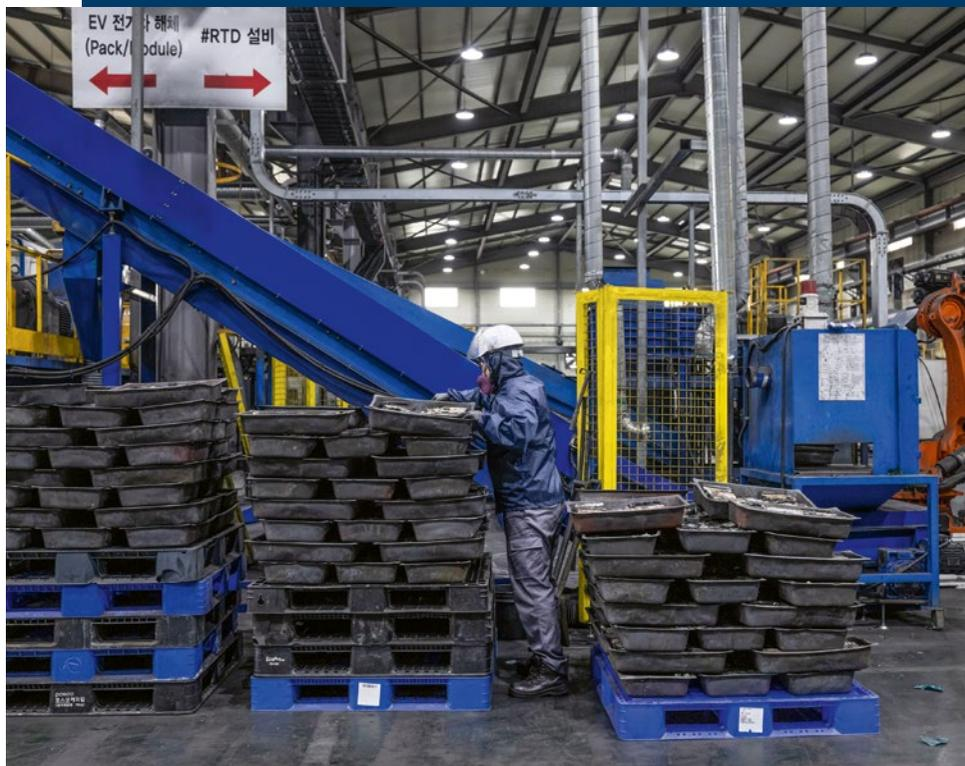
In dieser südkoreanischen Fabrik werden alte und defekte Lithium-Ionen-Batterien geschreddert. Aus dem dabei entstehenden Pulver, der sogenannten schwarzen Masse (unten), lassen sich wertvolle Rohstoffe wie Nickel, Kobalt und Lithium zurückgewinnen.
