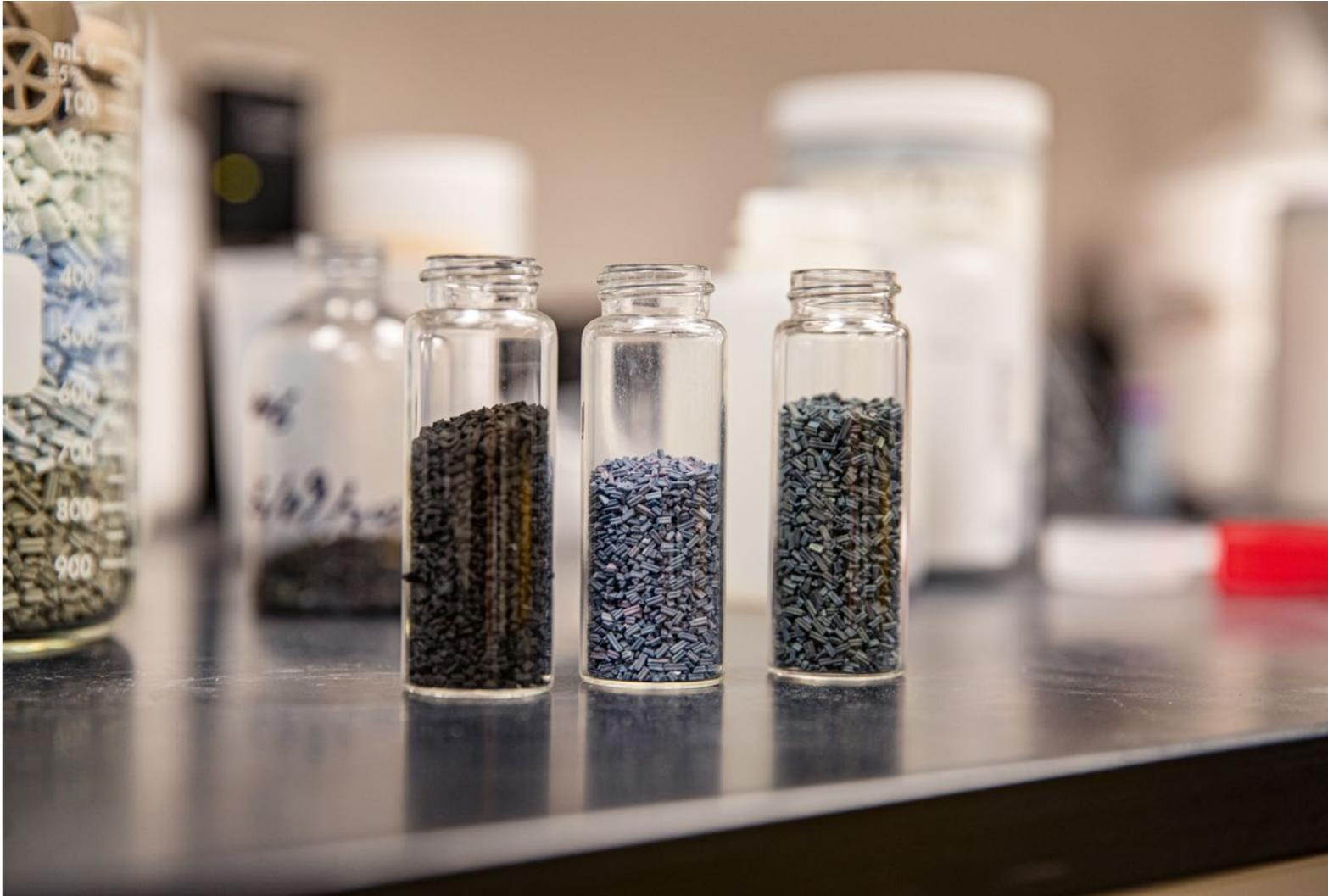
Verbrauchte Katalysatoren sind schwarz von Koks und Schwefel. Frische und verjüngte Katalysatoren haben unterschiedliche Farben.
