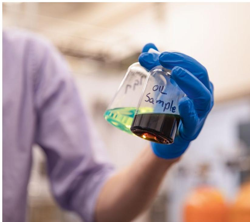
Vom Rohstoff zum Kraftstoff: Andrew Kincannon, der Leiter des Technikums, mit Proben von dunklem Rohöl und raffiniertem, entschwefeltem Kraftstoff
