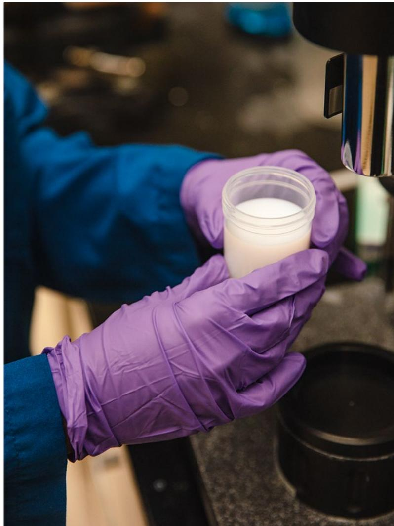
Feine Sache: Die Nanopartikel aus Silica schweben in einer milchigen Dispersion. Sie sind perfekt geeignet als Schleifmittel für Mikroprozessoren.
