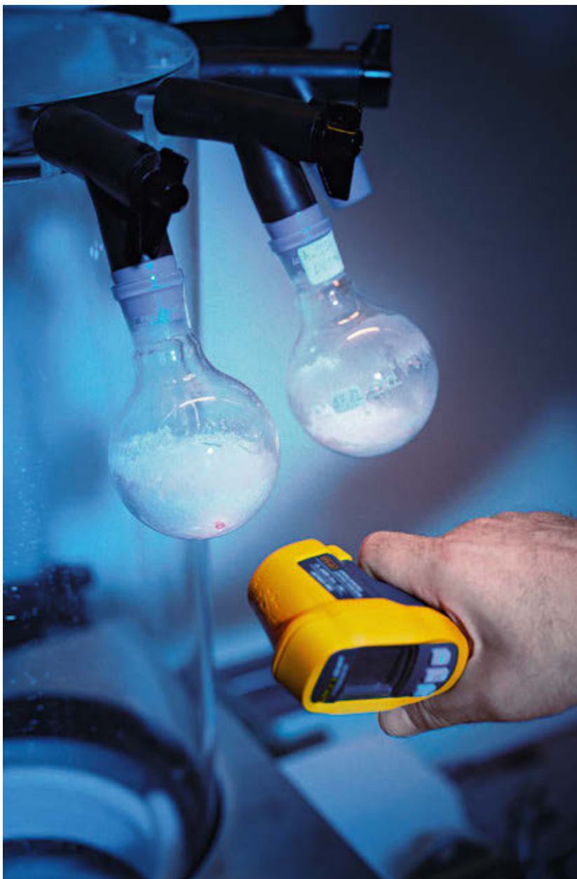
Durch Gefriertrocknung wird aus der Reaktionslösung rPEG-Lipid in Pulverform gewonnen.
