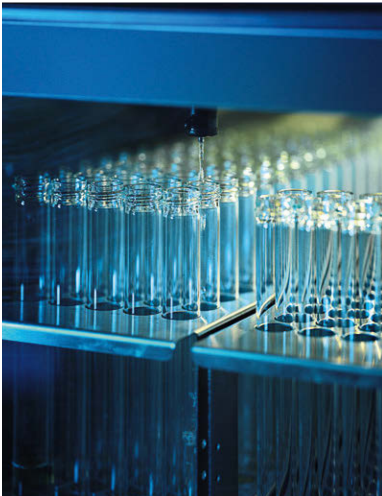
Die verschiedenen Fraktionen der Chromatografie werden in Reagenzgläsern aufgefangen.
