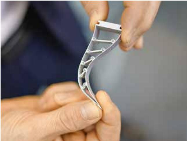
Ralf Düssel sieht in der Zukunft vielfältige Einsatzmöglichkeiten für Kunststoff – so wie für dieses 3D-gedruckte Bauteil (links), das in Robotergreifern zum Einsatz kommt.
