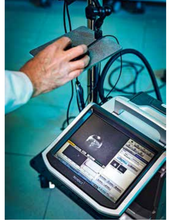
Mit einer Kamera wird im Labor untersucht, wie Tropfen auf einer Folie landen und sich darauf verhalten. Idealerweise bleiben sie haften und breiten sich aus.
