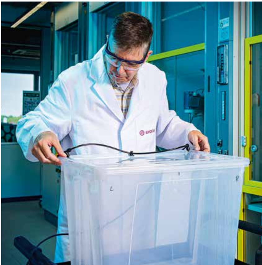
Forschung in der Kiste: Laborant Volker Klotzbach bereitet eine Box vor, um darin mit Adjuvanzien beschichtete Plastikfolien zu beregnen.
