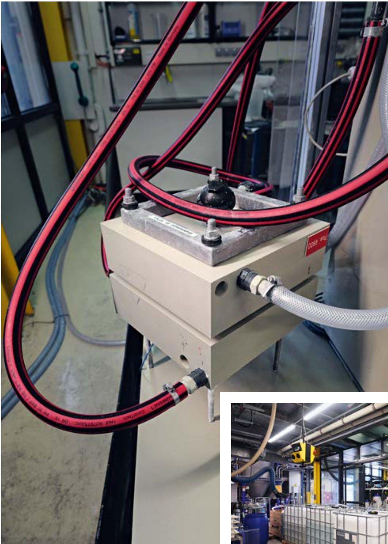
Herzstück: In dem Elektrodialyse-Stack wird das aus Vorlagebehältern eingeleitete Natriumsulfat gespalten. Die Forscher gewinnen Natronlauge und Schwefelsäure zurück.
