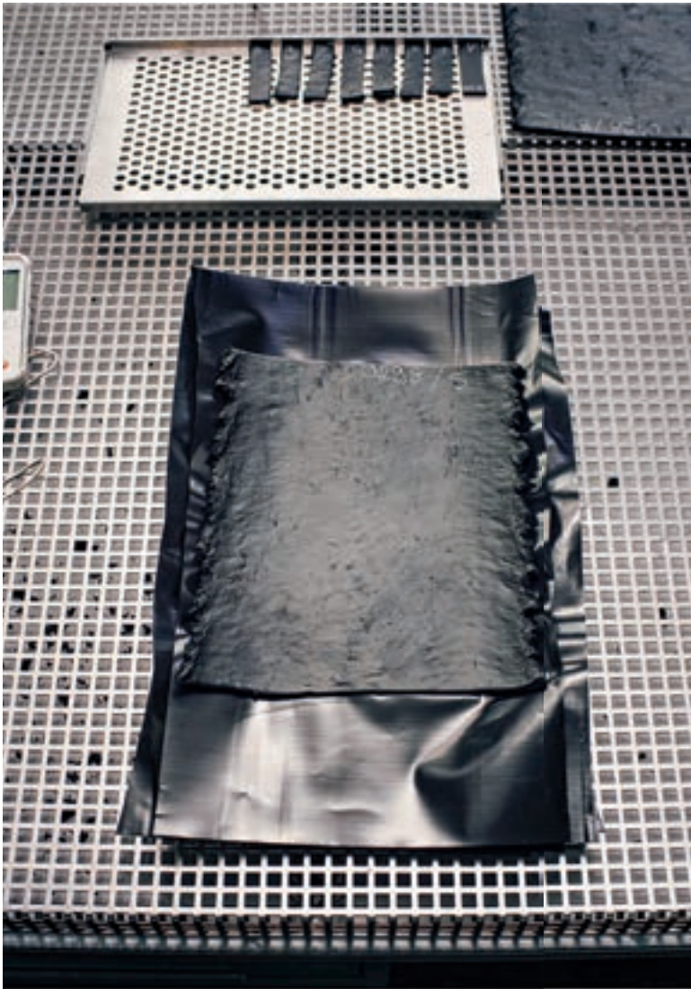
Schnittmuster: In der Anwendungstechnik am Standort Wesseling stellt Evonik Gummi für Prüfzwecke selbst her. Die für das jeweilige Testverfahren benötigten Formen werden vor der Vulkanisation zugeschnitten.
