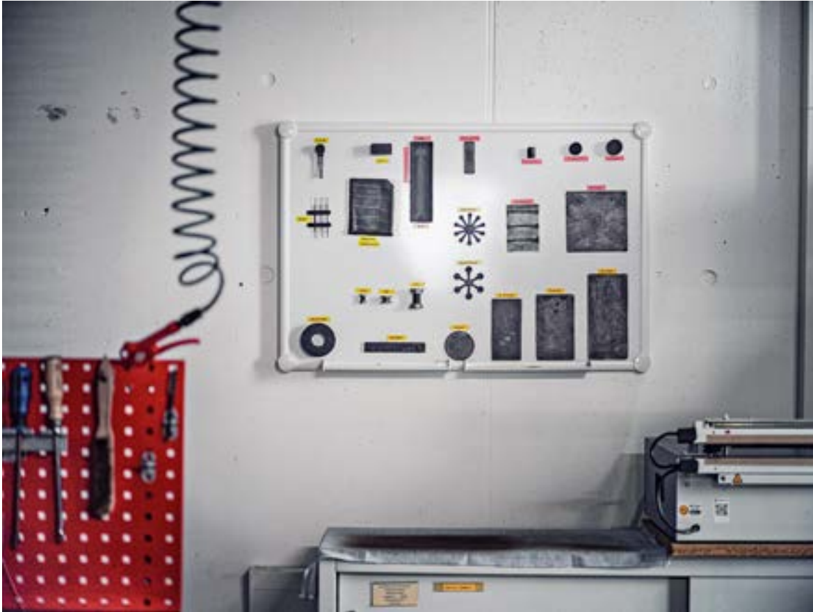
Mustervielfalt: Um die Eigenschaften eines Gummis zu ermitteln, führt Evonik viele standardisierte Tests mit definierten Prüfkörpern in unterschiedlichen Formen durch.
