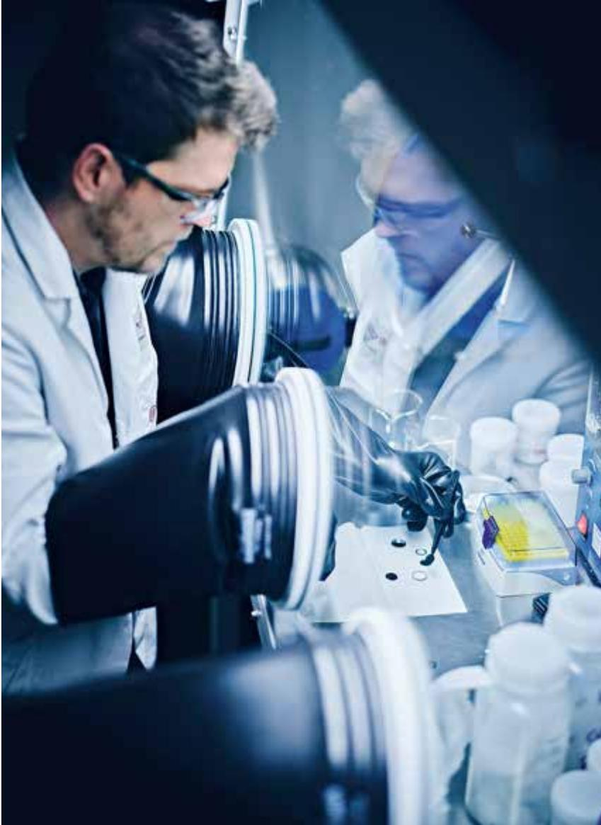
Um den Festelektrolyten auf Praxistauglichkeit zu testen, baut Frank Löffler das Material in Knopfzellen ein.
