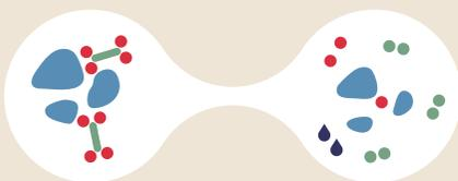
**Eisenpartikel** reagieren direkt mit den giftigen **Chlorverbindungen** und spalten das Chlor ab.
