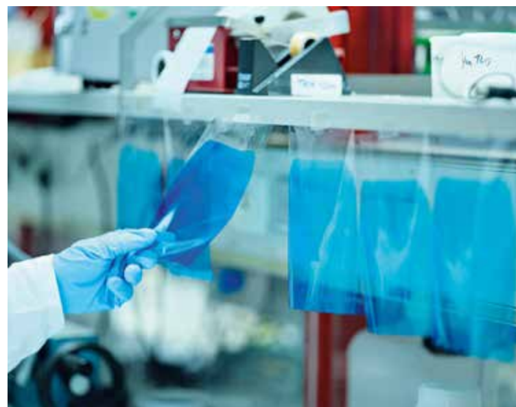
Um Kunststoffverpackungen hochwertig zu recyceln, muss die aufgedruckte Farbe entfernt werden. Das testen die Experten im Labor in Essen Goldschmidtstraße an Kunststoffschnipseln.
