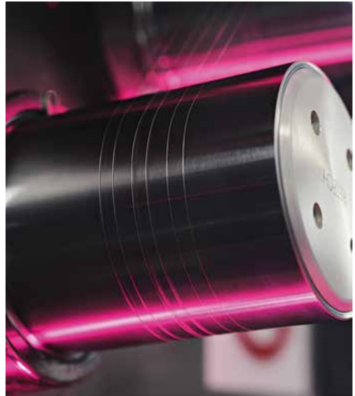
Zum Trocknen läuft der Faden über beheizte Walzen (o.). Die anschließende Qualitätskontrolle umfasst auch die Messung der Zugfestigkeit direkt in der Spinnerei.
