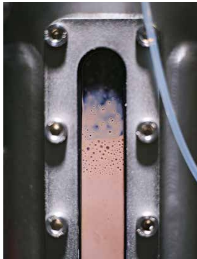
Im Labor von Amsilk nimmt Prozessingenieurin Nadine Ersig eine Probe aus der laufenden Kultivierung in einem Fermenter. Während die Bakterien in der Nährlösung wachsen, produzieren sie das Seidenprotein.
