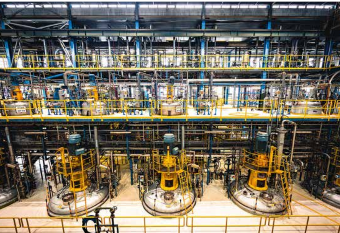
Bei Evonik Femas in der Slowakei läuft die Fermentation im industriellen Maßstab: 50.000 Liter Biomasse fassen die Fermenter in der Produktionshalle.
