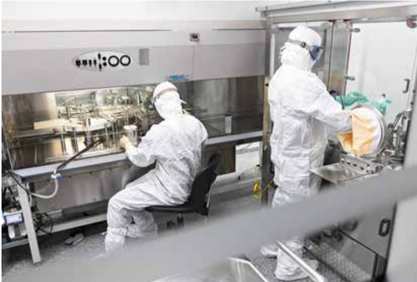
Evonik-Mitarbeiter im Schutzanzug überwachen in einem Reinraum die Abfüllung von Lipidnanopartikeln in Ampullen.
