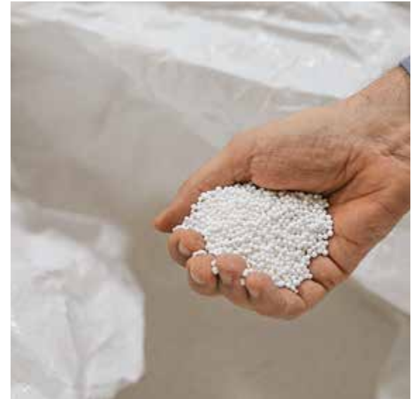
Frisch hergestellte Adsorbentien sind weiß. Während der Reinigung von Pyrolyseöl verfärben sie sich grau.
