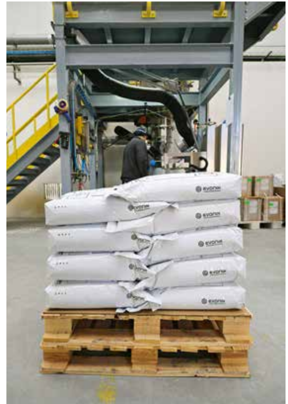
Die Platten mit den Sporen werden maschinell zerbröselt, mit Hilfsstoffen vermengt und für den Transport zu den Kunden in Säcke abgefüllt.
