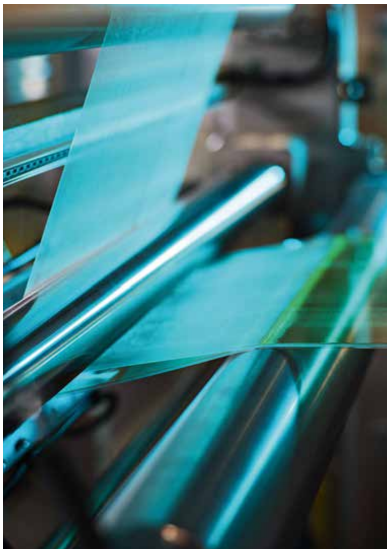
Bei der Herstellung von Duraion ist das Zusammenspiel von Materialwissenschaft und Polymerchemie entscheidend – etwa bei der präzisen Einbettung der Gewebeverstärkung in die Polymerlösung.
