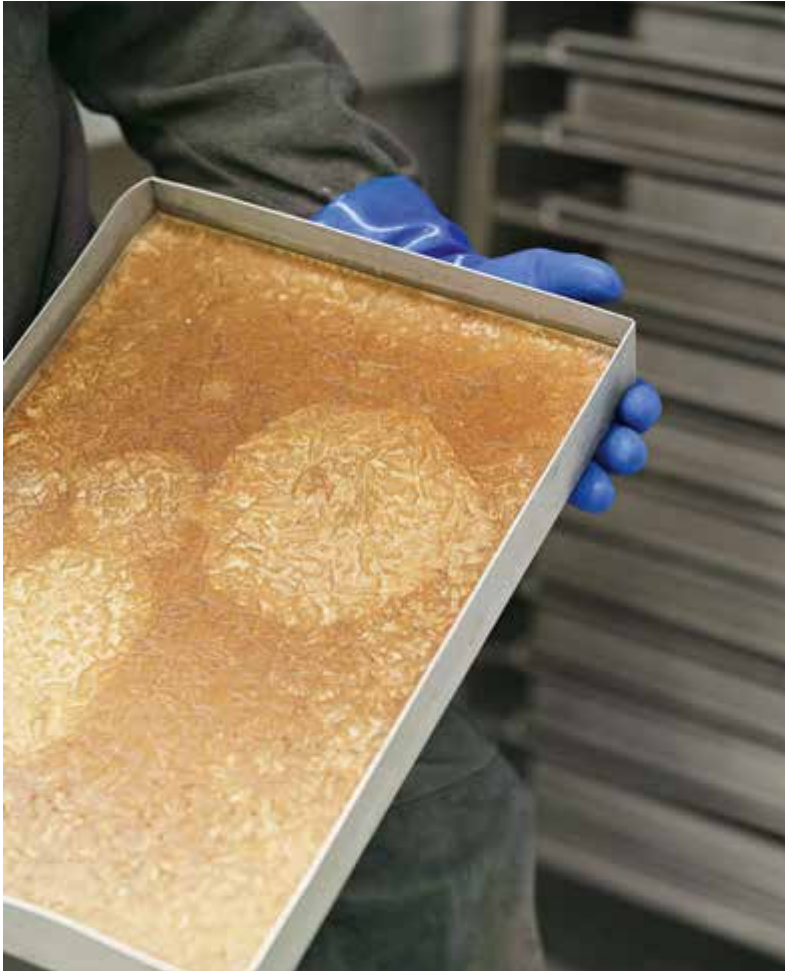
Nach der Fermentation wird die Biomasse zentrifugiert, zu Platten schockgefrostet und gefriergetrocknet.
