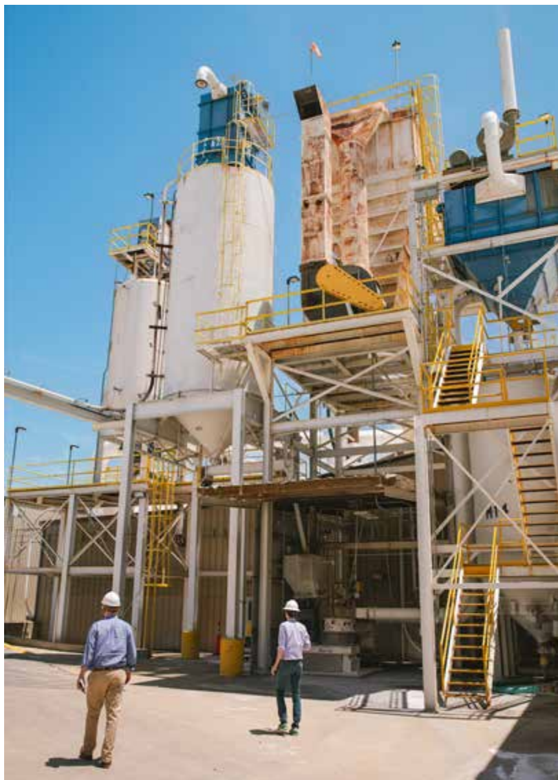
Der Evonik-Standort in Little Rock (Arkansas) ist darauf spezialisiert, gebrauchte Katalysatoren so aufzubereiten, dass sie wieder eingesetzt werden können.
