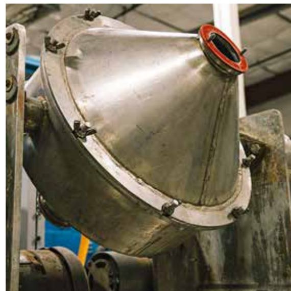
In Trommelbehältern werden katalytisch aktive Metalle auf einem Adsorbensmaterial verteilt, das unerwünschte Inhaltsstoffe des Ausgangsmaterials abtrennen und dann binden kann.
